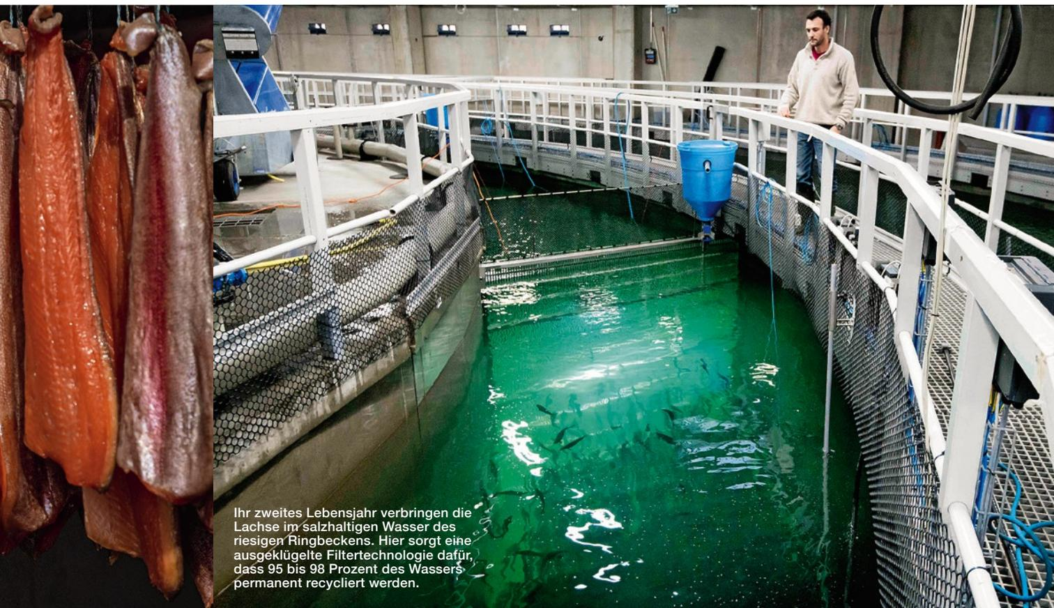
Ihr zweites Lebensjahr verbringen die Lachse im salzhaltigen Wasser des riesigen Ringbeckens. Hier sorgt eine ausgeklügelte Filtertechnologie dafür, dass 95 bis 98 Prozent des Wassers permanent recycelt werden.
